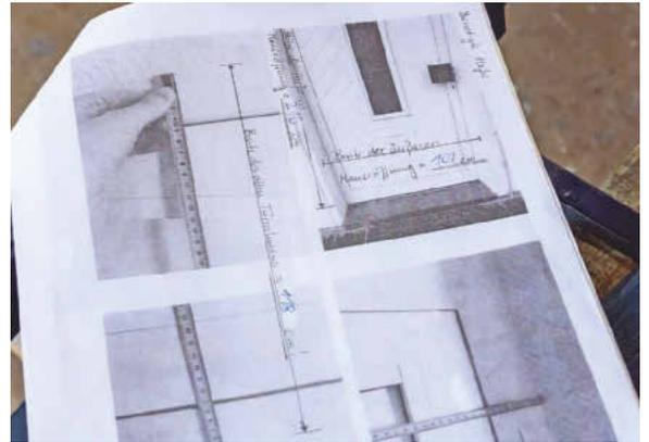
*! Viele Kunden machen das Aufmaß selbst: Dafür wurde ein System entwickelt, mit Zeichnungen, die die exakte Anlage der Messpunkte definiert, die in einem Messprotokoll eingetragen werden müssen.*
